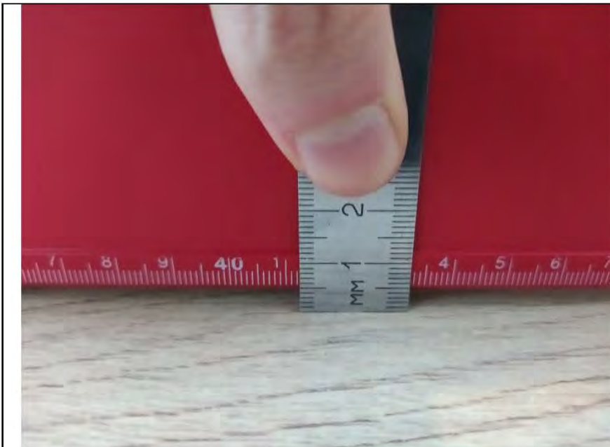
Фото №16. Измерения уровня напольного покрытия в спальне.
