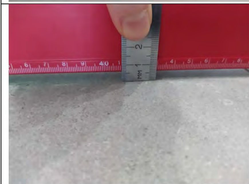
Фото №18. Измерения уровня напольного покрытия в прихожей (керамическая плитка).
