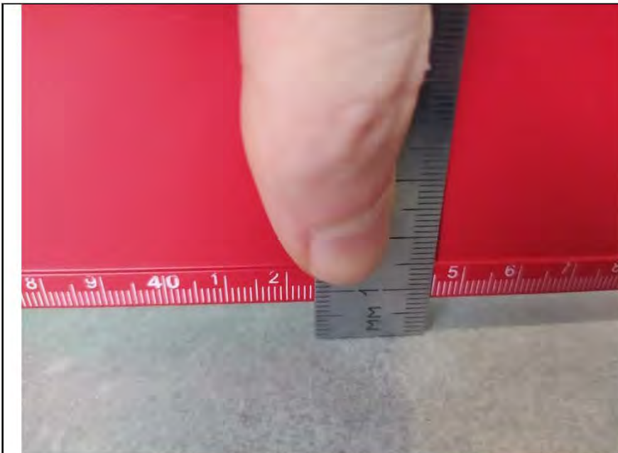
Фото №19. Измерения уровня напольного покрытия в кухне (керамическая плитка).
